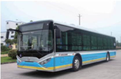
12米纯电动，整车车身设计采用方基型，配合部分流线造型，外形美观大方，首次采用高强度的铝合金车身。对整车轻量化、节能降耗起到较好的效果
