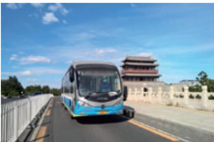
BRT1线双源无轨电车
