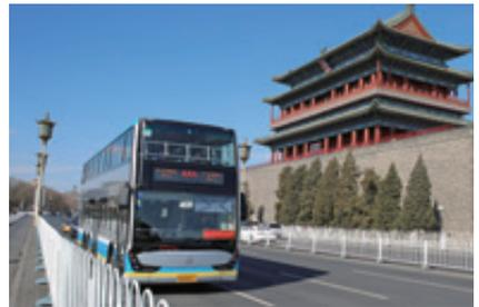
纯电动双层车，外形美观大方，首次采用高强度的铝合金车身。装配纳米高功率多元锂离子电池，总电量达139.2度，采取直充式充电，一次充电仅需20分钟左右
